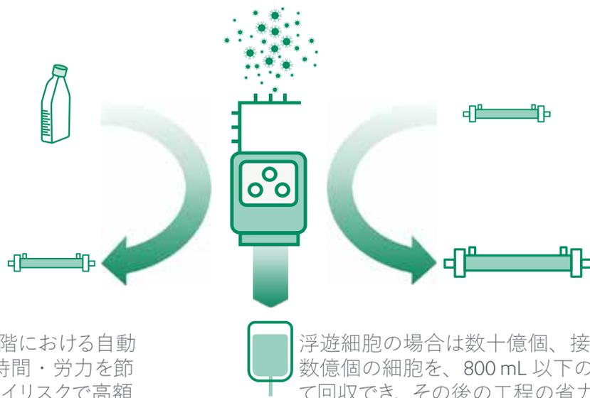
小型リアクターと標準サイズリアクターを付け替えることによって、バッチサイズのシームレスな拡大が可能です。
